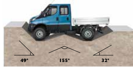
Yaklaşma açısı Rampa açısı Ayrılma açısı
